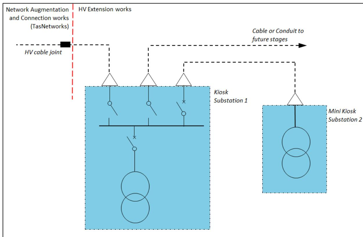
**Figure 4: Kiosk connection with remote mini kiosk.**
