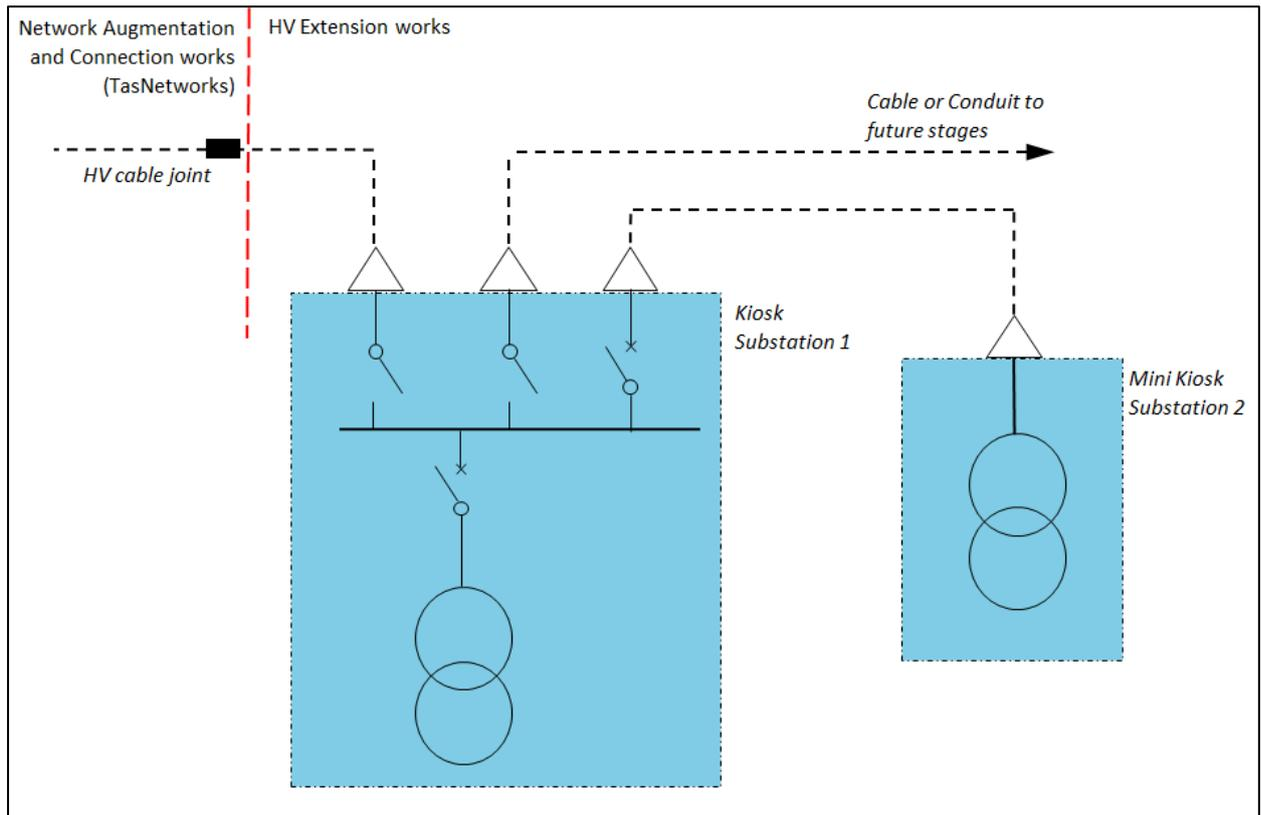
**Figure 4: Kiosk connection with remote mini kiosk.**
